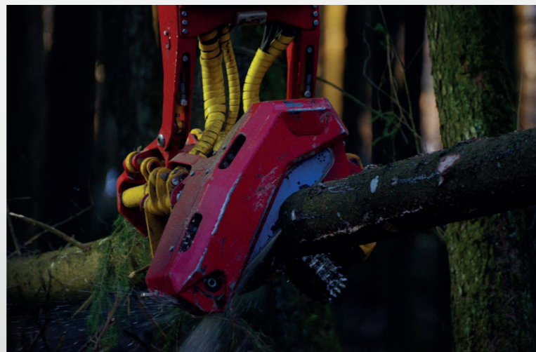
Der Woody verfügt über eine hohe Baulänge, die ein kontrolliertes Fällen starker Bäume ermöglicht.
