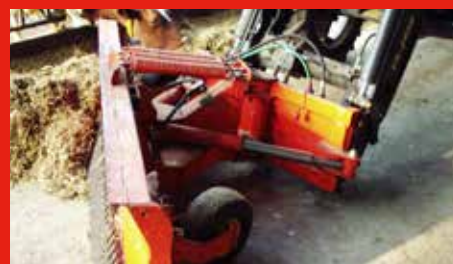
Teleskopzylinder zur Vergrößerung der Schrägstellung auf bis zu 35° am Modell GT-FL.
