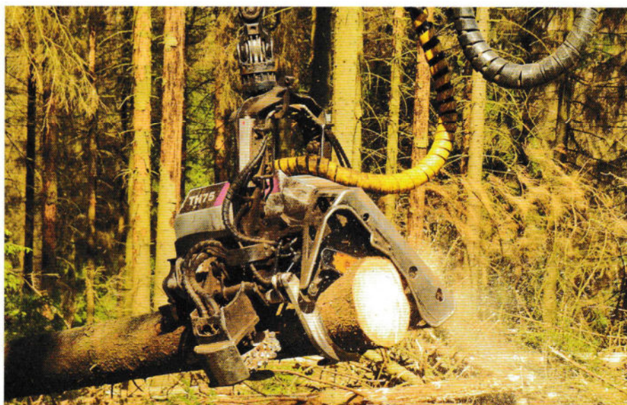
Als Aggregat hängt das Logset TH 75 an der Kranspitze. Fälldurchmesser 75 Zentimeter.
