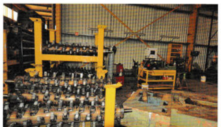
Ein wichtiger Vorgang: Diese Rotatoren liegen bereit zum Auswuchten. Im Hintergrund ist die Auswuchtmaschine zu sehen.
