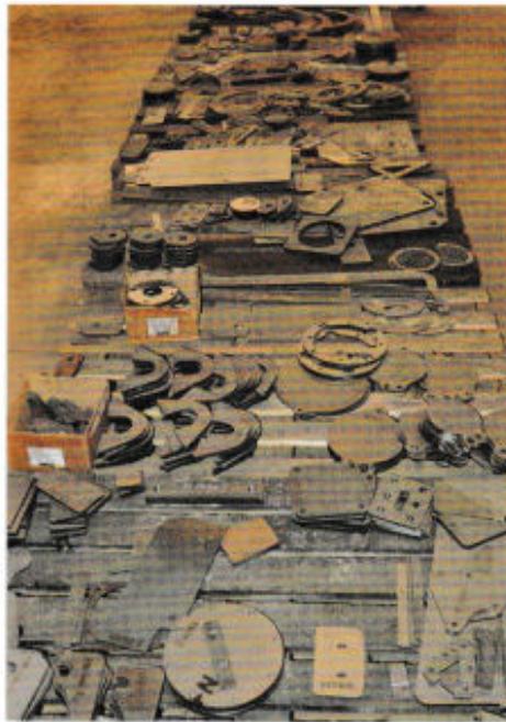
Oben: Die Laserschneidemaschine liefert saubere Schnittkanten und präzise Maße. Zudem können per Computer die Teile so auf der Platte zusammengestellt werden, dass nur wenig Verschnitt übrigbleibt. Das spart Material und damit Kosten.
