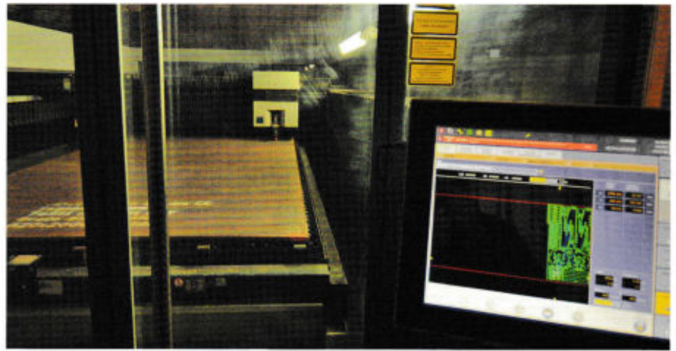
Oben: Die Laserschneidemaschine liefert saubere Schnittkanten und präzise Maße. Zudem können per Computer die Teile so auf der Platte zusammengestellt werden, dass nur wenig Verschnitt übrigbleibt. Das spart Material und damit Kosten.
