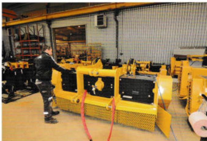
Endmontage an einem großen Mulchgerät. Dieses Gerät soll an ein Raupenfahrzeug angebaut werden.
