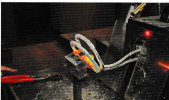
Die Werkzeuge/Zähne werden auf den Träger mit Hilfe des Induktionsschweißverfahrens bombenfest aufgeschweißt.
