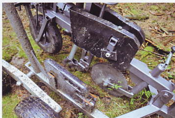
So funktioniert Quadsaat: Schneidrad, Saatschar und Füllrad.
