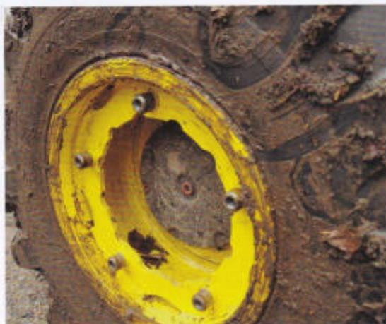
Links: Den Original-Rädern am Skidder wurden neue Felgen verpasst, die je fünf Aufnahmezapfen mit innenliegendem Gewinde besitzen.
