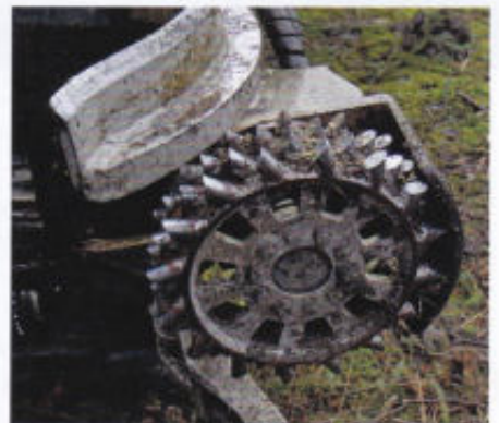
Oben: Der Schutzbügel über der Haube ist eine Option wie auch die wuchtige Stoßstange. Sie bietet eine Knautschzone, aber auch Platz für zwei extra Scheinwerfer und Stauraum. Unten links: Ebenfalls eine Option sind das Farbmarkierungssystem im Sägekasten und besonders aggressive Walzen am Harvesterkopf (rechts).
