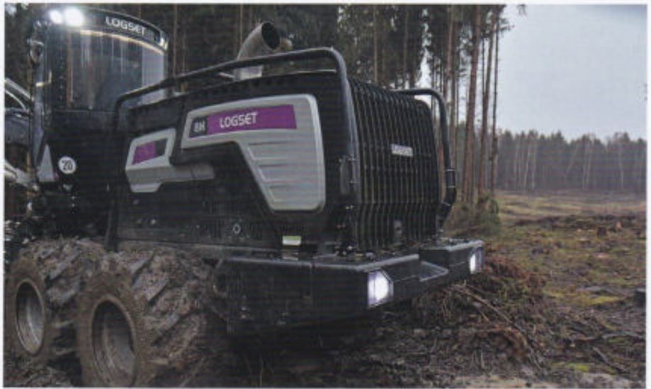
Oben: Der Schutzbügel über der Haube ist eine Option wie auch die wuchtige Stoßstange. Sie bietet eine Knautschzone, aber auch Platz für zwei extra Scheinwerfer und Stauraum. Unten links: Ebenfalls eine Option sind das Farbmarkierungssystem im Sägekasten und besonders aggressive Walzen am Harvesterkopf (rechts).
