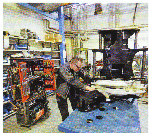
Oben links: Tom Knipström im Lager des Service Center beim Flughafen Vaasa. Oben rechts: Hier wird gerade ein Rückezug für einen französischen Kunden auf die Räder gestellt. Links: Schweißarbeiten an einem Harvesterkopf-Chassis. Rechts: Zusammenbau eines Harvesterkopfes. Bei der Aggregatfertigung hat Logset eine hohe Produktionstiefe. Werkstattfanatiker schauen sich bitte mal den Werkzeugwagen an. Na, kommt da etwa Neid hoch ..?
