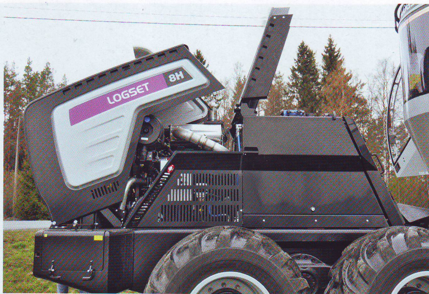
Die Motorhaube wird elektrisch geöffnet, die Abdeckung der Hydraulikeinheit kann per Hand hochgeklappt werden. Die Zugänglichkeit der Maschine ist gut und praktikabel.
